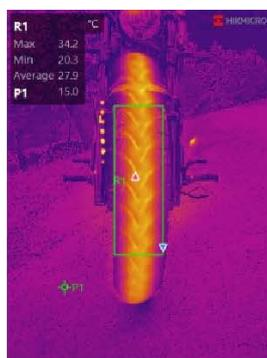
Neumático delantero. Calor de los neumáticos y patrón de desgaste
