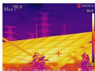
Inspección de paneles solares
